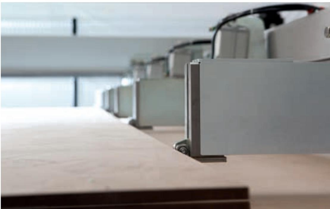
Le **pinze** prelevano automaticamente la quantità necessaria di pannelli in base allo schema di lavorazione incrementando l'efficienza e la sicurezza della sezionatrice senza aumentarne gli ingombri.
