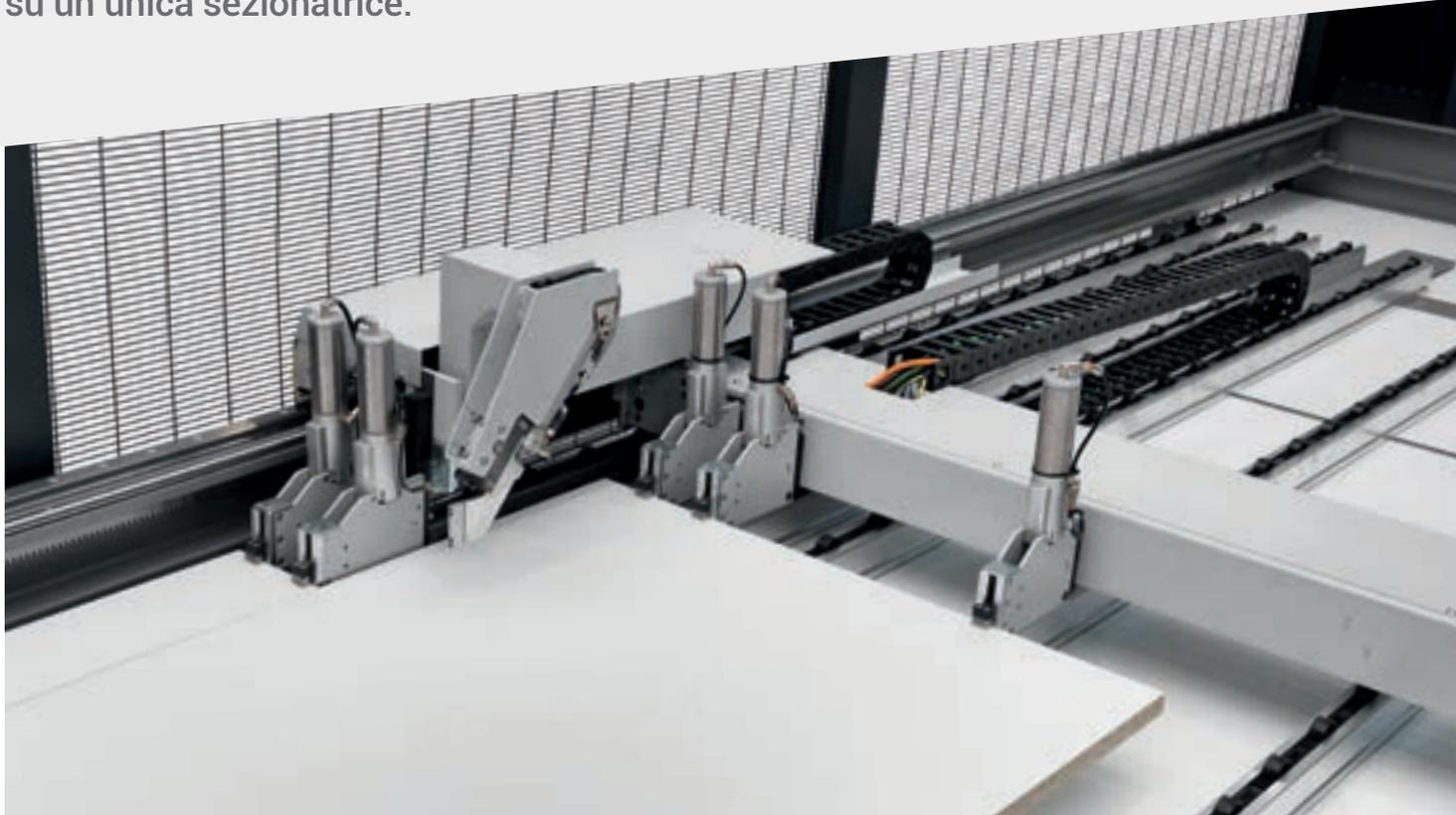
Il sistema Twin Pusher fornisce uno spintore ausiliario composto da due pinze fisse. Consente il taglio simultaneo riducendo così drasticamente il ciclo di taglio.
