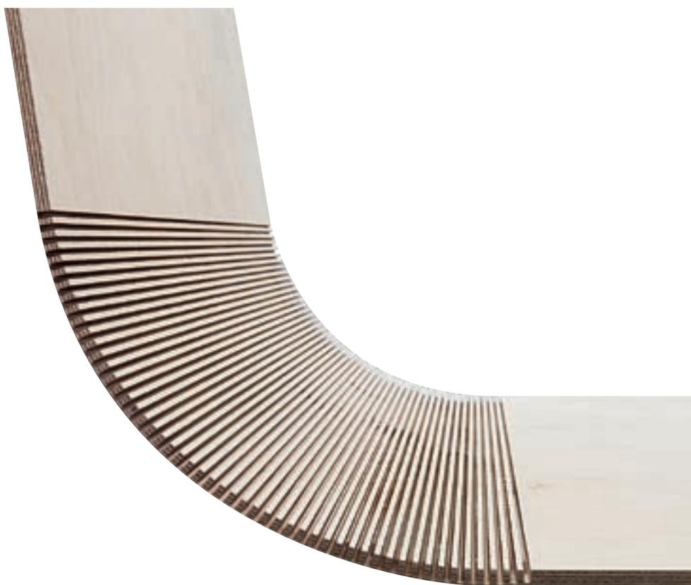
Sistema per l'esecuzione automatica delle scanalature la cui larghezza può essere programmata tramite il controllo numerico. La profondità della scanalatura può essere regolata manualmente dall'esterno del corpo macchina e con lame in movimento.
